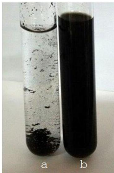
شکل 3 افزایش میزان پراکندگی نانولوله‌های کربن در آب پس از عامل‌دار کردن با آرژنین a: نانولوله کربنی در آب b: Arg-SWNT مخلوط در آب.
