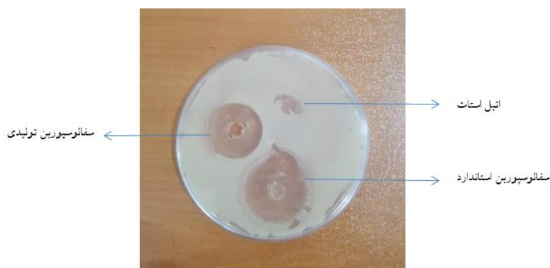
شکل ۸ هاله عدم رشد برای سفالوسپورین تولیدی (غلظت ۲۰۰ میلی گرم بر لیتر) در مقایسه با سفالوسپورین استاندارد (غلظت ۲۰۰ میلی گرم بر لیتر)
