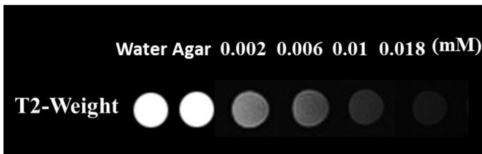
شکل ۵ تصویر فانتوم MRI وزن T2 از غلظت‌های مختلف آهن در نانوذرات MOF@Cu-ferrite.
