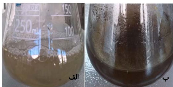
شکل ۱) تغییر رنگ محلول‌های واکنش قبل و پس از تولید نانوذرات الف) تغییر رنگ محلول‌های واکنش قبل از تولید شدن نانوذرات پالادیوم ب) تغییر رنگ محلول‌های واکنش پس از تولید شدن نانوذرات
