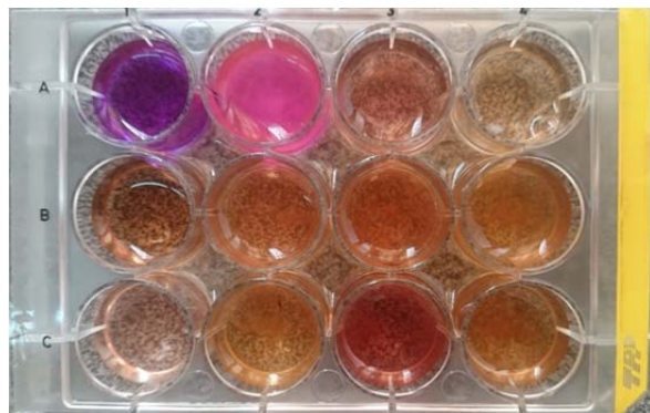
شکل ۳) آزمایش رزازورین و میزان تغییر رنگ در اثر رشد باکتری
