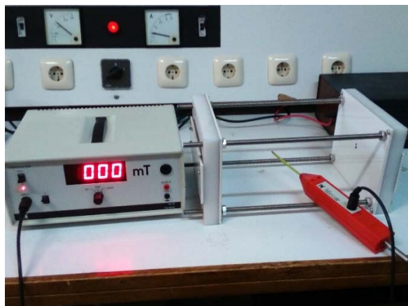
شکل ۱) دستگاه طراحی و ساخته‌شده همراه تسلا متر برای اندازه‌گیری شدت مغناطیسی
