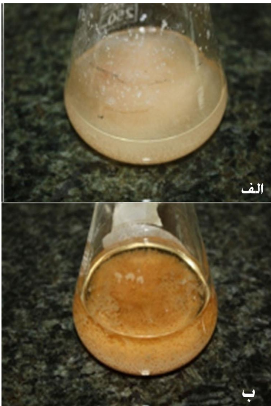
شکل 1 بیومس قارچ پنی سیلیوم قبل (الف) و پس از (ب) قرار گرفتن در معرض محلول نیترات نقره. تغییر رنگ محلول واکنش از بی رنگ به قهوه‌ای مایل به زرد، نشان‌دهنده تولید نانوذرات نقره است.
