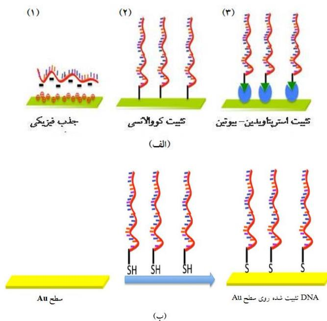
شکل ۳ (الف) روش‌های ثبیت آپتامر روی سطح (۱۵)، (ب) ثبیت DNA روی سطح طلا به روش کووالانسی [۱۵].
