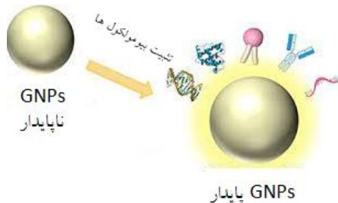
شکل ۲ اتصال عناصر زیستی مختلف روی سطح GNPs.
