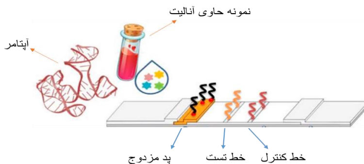
شکل ۱۰ تصویری از سنجش جریان جانبی. حرکت یک نمونه و GNPs دارای برچسب آپتامر در سراسر نوار بیانگر نتیجه مثبت یا منفی آزمون است [۱۸].
